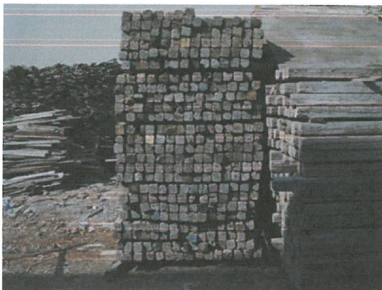
Εικ. 4. Ακατάλληλη εισαγόμενη ξυλεία ξυλοτόπων από ερυθρελάτη
